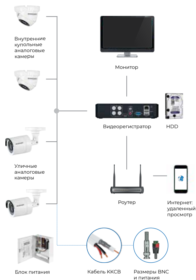
Типовая схема построения системы видеонаблюдения на базе аналогового оборудования
